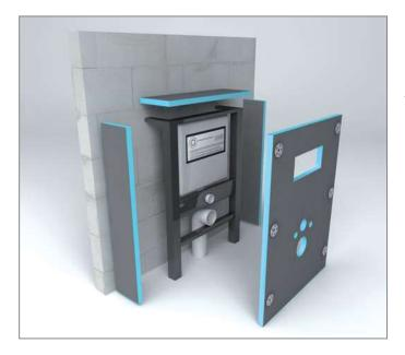
wedi I-Board (1 200 x 1 245 x 20 mm) est un élément de montage préparé et destiné à l'habillage des WC suspendus. Facilement adaptable aux besoins de chacun grâce à une largeur de 1 200 mm. Solidité et résistance extrêmes en dépit d'un poids faible (résiste jusqu'à 400 kg à partir d'un format de carreaux de 10 x 10 cm). Après installation, le carrelage peut être posé sans traitement préalable.
