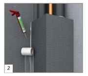
Coller au mur l'élément en forme de L avec la colle polymère wedi 610. Appliquer la bande d'armature autocollante wedi Tools sur le raccord d'angle.
